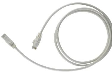
Bretella di collegamento di **categoria 6A U/UTP** con connettori Keystone RJ-45; **lunghezza 0,5m**. Le caratteristiche soddisfano i requisiti di **CAT 6A Classe EA** fino a **250 MHz** secondo gli standard **ANSI/TIA-568-C.2 e ISO/IEC 11801**.
